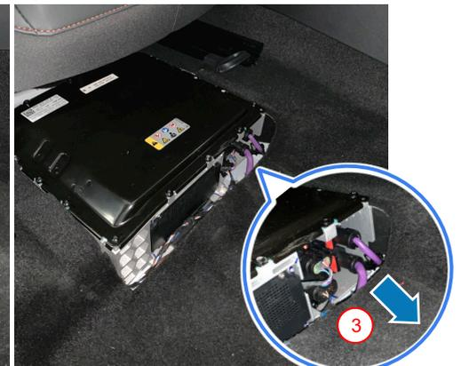
En cas d'accident entraînant le déploiement de l'airbag, le système électrique de 48 volts du véhicule est désactivé automatiquement et immédiatement après détection du déploiement de l'airbag. La batterie de 48 volts est également désactivée lorsque vous coupez le contact.
