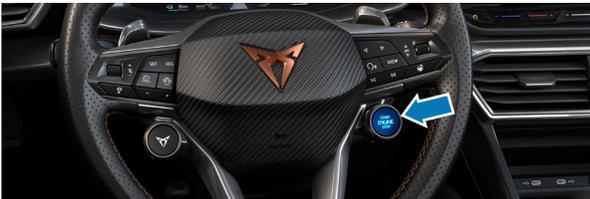
Appuyez sur le bouton START - ENGINE - STOP situé sur le volant multifonction sans actionner la pédale de frein.
