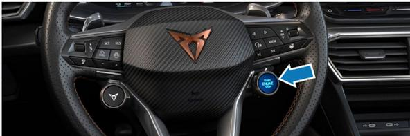
Den START - ENGINE - STOP Knopf, der sich am Multifunktionslenkrad befindet, drücken, ohne das Bremspedal zu betätigen.
