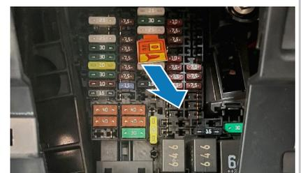
Ziehen Sie am Etikett, um die Sicherung zu trennen.
