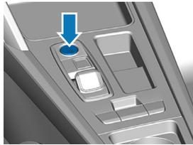
Den START-ENGINE-STOP-Knopf, die sich je nach Modell am Multifunktionslenkrad bzw. in der Mittelkonsole befindet, ohne das Bremspedal zu betätigen.
