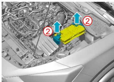
2. (Variante 1) Utilizzando un utensile idoneo, scollegare la batteria a 12 V della rete di bordo nel vano motore.
