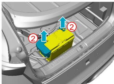
2. (Variante 2) Utilizzando un utensile idoneo, scollegare la batteria a 12 V della rete di bordo nel bagagliaio.
