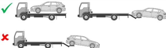
Fahrzeug nicht auf der Antriebsachse abschleppen. Hochvoltsystem deaktivieren (siehe Kapitel 3). Fahrzeug in sicher Entfernung von Gebäuden und anderen Fahrzeugen abstellen (min. 5 m) (Quarantänefläche).
