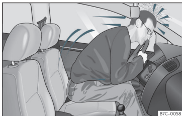
Fig. 7 Le conducteur n'ayant pas bouclé sa ceinture est projeté en avant.
