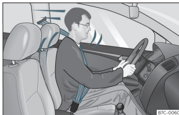
Fig. 6 Les conducteurs qui ont correctement bouclé leur ceinture de sécurité ne seront pas projetés en cas de freinage soudain.
