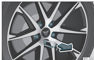
Fig. 35 Roue : boulons de roue avec capuchons.
