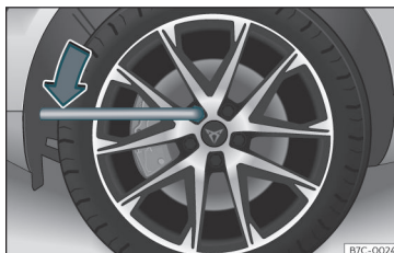
Fig. 37 Changement de roue : desserrer les vis de roue.
