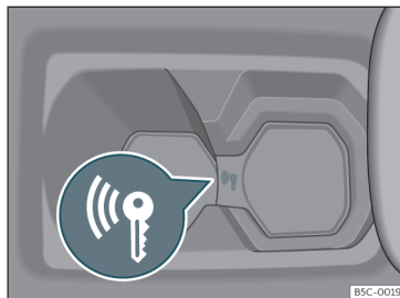
Abb. 143 In der Mittelkonsole: Notstart.
