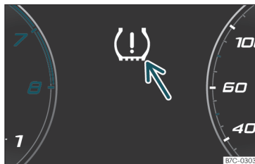
Abb. 215 Kombi-Instrument: Warnung Reifendruckverlust.
