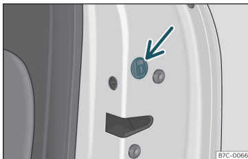
Abb. 79 Notfallsperre der Tür.
