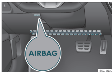
Abb. 17 Auf der Fahrerseite: Einbauort des Knieairbags.
