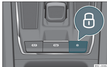
Abb. 75 In der Mittelkonsole: Zentralverriegelungstaster
