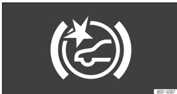
Abb. 156 Am Bildschirm des Kombi-Instruments: Anzeigen der Vorwarnung.
