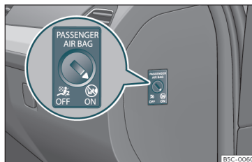
Abb. 15 Schlüsselschalter zum Ein- und Abschalten des Beifahrerairbags.
