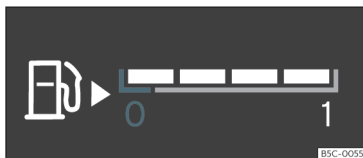
Abb. 59 Kraftstoffvorratsanzeige an verschiedenen Stellen je nach Ansicht.
