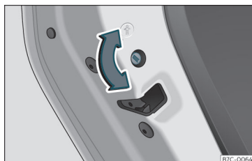
Abb. 80 Kindersicherung in der linken Tür
