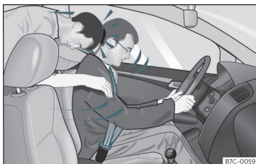
Abb. 8 Der nicht angegurte Mitfahrer auf dem Rücksitz schleudert nach vorn auf den angegurten Fahrer.
