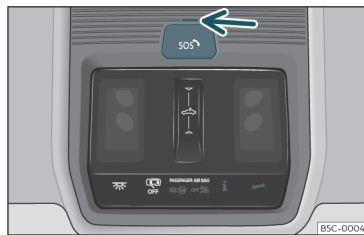
Abb. 32 In der Dachkonsole: Schalter für Sprachdienste
