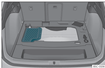
Abb. 211 Einbauort der Batterie im Kofferraum
