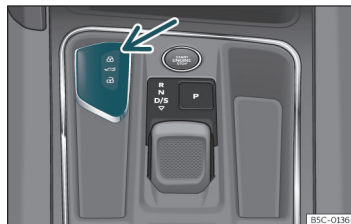
Abb. 70 Mittelkonsole: Aufnahme für den Fahrzeugschlüssel
