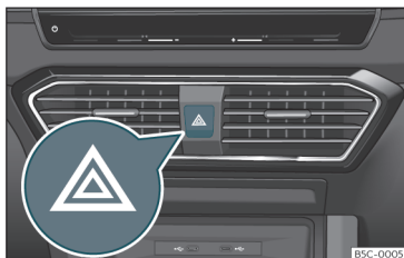
Abb. 91 Instrumententafel: Schalter für Warnblinkanlage.
