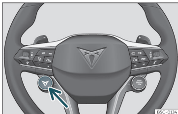
Abb. 147 Multifunktionslenkrad*: Schalter für den Fahrprofilwechsel
