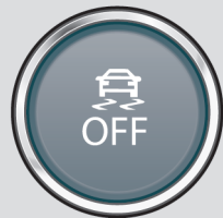
Abb. 177 Im unteren Teil der Mittelkonsole: Taste zum Ein-/Ausschalten von ESC
