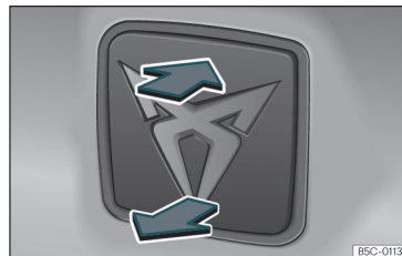
Abb. 81 Heckklappe: Öffnen von außen.
