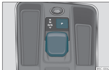
Abb. 145 In der Mittelkonsole: Wahlschalter.
