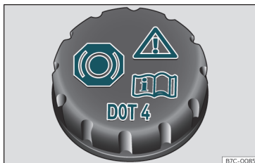
Abb. 208 Motorraum: Deckel des Bremsflüssigkeitsbehälters.
