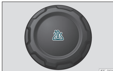
Abb. 207 Motorraum: Deckel des Motorkühlmittelausgleichsbehälters.
