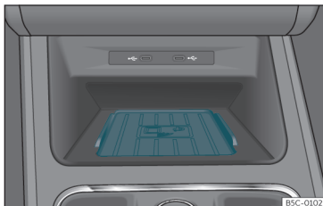
Abb. 139 In der Mittelkonsole: Aufnahme für die Mobiltelefonkopplung.
