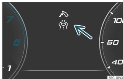
Fig. 54 Indication de l'assistance pour une conduite écologique (représentation schématique).
