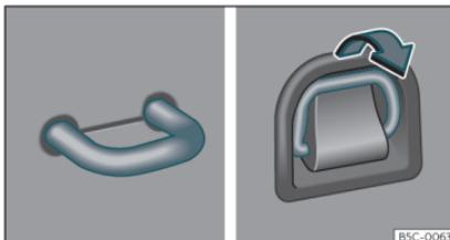
Fig. 111 Dans le coffre à bagages : œillets d'arrimage fixe et modulable.
