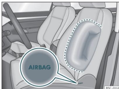
Fig. 21 Airbag latéral dans le siège du conducteur.
