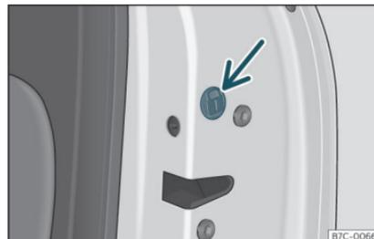
Fig. 75 Verrouillage d'urgence de la porte.
