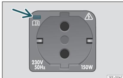
Fig. 122 Du côté droit du coffre à bagages : prise de courant de 230 volts.
