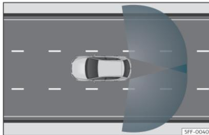
Fig. 144 Zones de détection des capteurs
