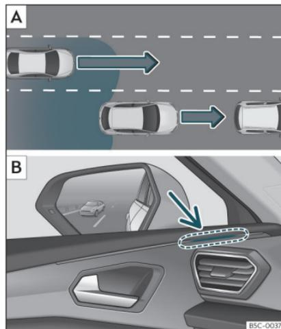
**Fig. 162** Représentation schématique : **A** En cas de dépassement en présence de trafic à l'arrière du véhicule. **B** Indication de l'assistant de changement de voie sur le voyant de contrôle du côté gauche.
