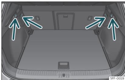
**Fig. 114** Dans le coffre à bagages : crochets pour sacs.
