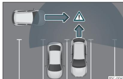
**Fig. 164** Représentation schématique de l'assistant de sortie de stationnement : zone surveillée autour du véhicule sortant de stationnement.
