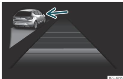
Fig. 153 Sur l'écran du tableau de bord : ACC activé, véhicule circulant à gauche détecté
