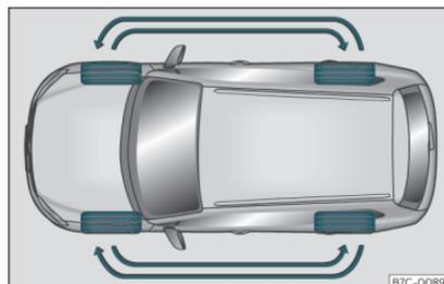
Fig. 195 Permutation des roues.
