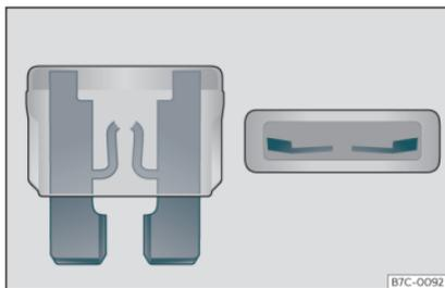
Fig. 49 Représentation d'un fusible grillé.
