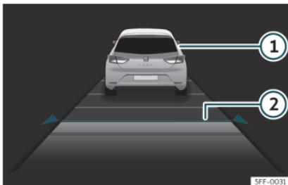
Fig. 152 Sur l'écran du tableau de bord : ACC actif.
