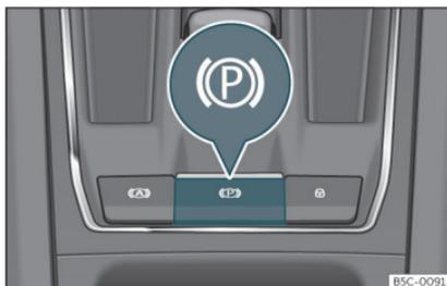
**Fig. 167** Sur la partie inférieure de la console centrale : touche du frein de stationnement électronique.
