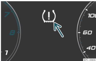
**Fig. 196** Combiné d'instruments : avertissement de perte de pression des pneus.
