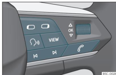
**Fig. 56** Partie droite du volant multifonction : touches permettant d'utiliser les menus et les messages d'information du tableau de bord.
