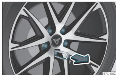
Fig. 35 Roue : boulons de roue avec capuchons.
