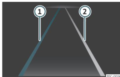
Fig. 156 Sur l'écran du tableau de bord : indications de l'assistant de maintien de voie.
