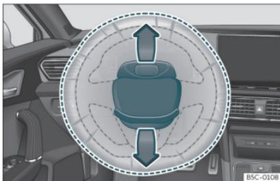
Fig. 13 Airbag du conducteur dans le volant.
