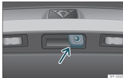
**Fig. 145** Sur la poignée du hayon : emplacement de la caméra de l'assistant de marche arrière.
