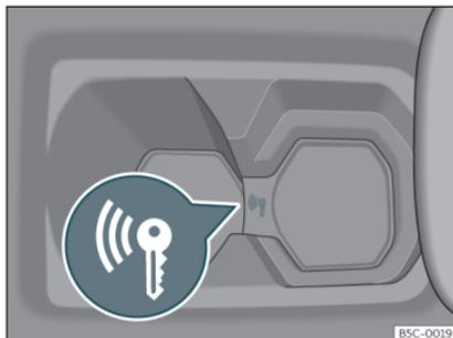
**Fig. 135** Sur la console centrale : démarrage d'urgence.
