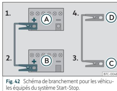
Fig. 42 Schéma de branchement pour les véhicules équipés du système Start-Stop.
