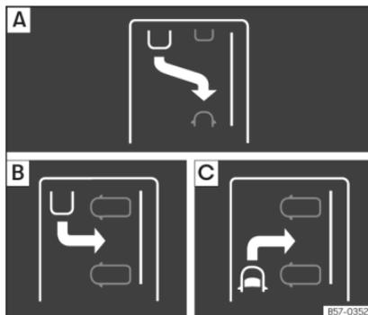
**Fig. 171** Sur l'écran du tableau de bord : indication des modes de stationnement.
