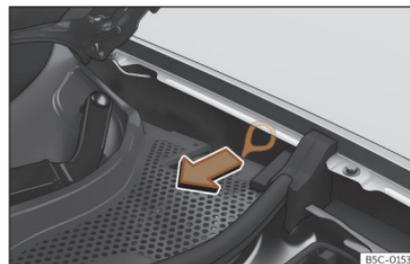
Fig. 197 Tra l'ala sinistra e la cerniera del cofano motore.: Maniglia per lo sblocco di emergenza del connettore di ricarica.
