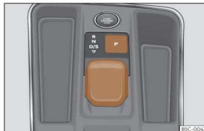
Fig. 145 Sulla console centrale: selettore.
