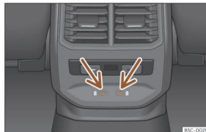
Fig. 140 Parte posteriore della console centrale: Connettori USB con funzione di presa di corrente.
