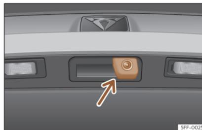
**Fig. 153** Nella maniglia del portellone posteriore: posizione della telecamera dell'assistente alla retromarcia.
