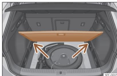
**Fig. 116** Piano variabile del bagagliaio: posizione inclinata.
