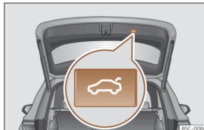
**Fig. 83** Portellone posteriore: tasto per chiudere il portellone.
