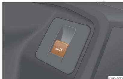
**Fig. 84** Sulla porta del conducente: tasto per aprire e chiudere il portellone posteriore.
