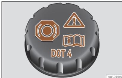
Fig. 215 Vano motore: tappo del serbatoio del liquido dei freni.
