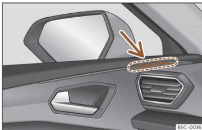
**Fig. 168** Spia di controllo assistente al cambio corsia.
