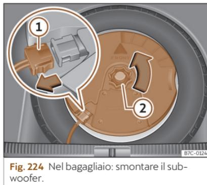
**Fig. 224** Nel bagagliaio: smontare il subwoofer.
