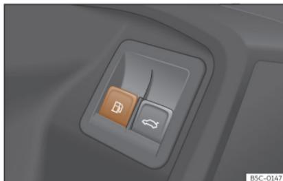
**Fig. 201** Porta del conducente: sblocco dello sportellino del serbatoio.
