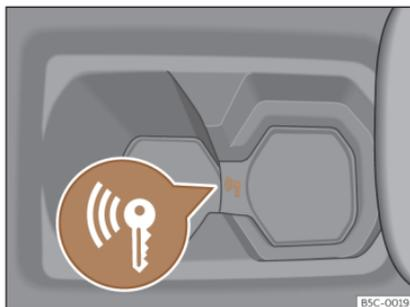
**Fig. 142** Sulla console centrale: avviamento di emergenza.
