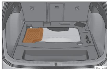
**Fig. 217** Veicoli ibridi (PHEV): alloggiamento della batteria all'interno del bagagliaio
