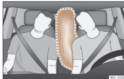
**Fig. 20** Airbag centrale completamente gonfiato (area di spiegamento).
