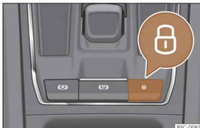
**Fig. 76** Sulla console centrale: interruttore della chiusura centralizzata
