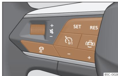
**Fig. 159** Sul volante multifunzione: tasti di comando dell'ACC
