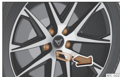
Fig. 35 Ruota: viti della ruota con tappi.
