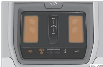
**Fig. 94** Dettaglio del rivestimento del tetto: illuminazione anteriore dell'abitacolo.
