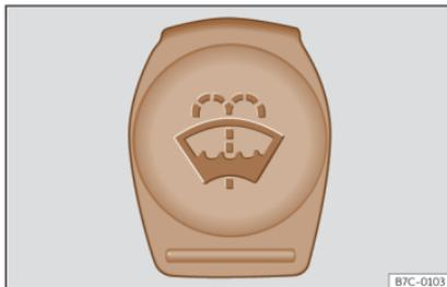
**Fig. 216** Nel vano motore: tappo del serbatoio del tergicristalli.
