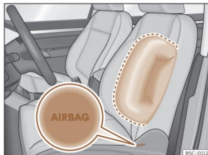
Fig. 21 Airbag laterale all'interno del sedile del conducente.
