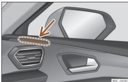
**Fig. 169** Spia di controllo assistente al cambio corsia.
