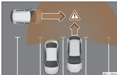
**Fig. 172** Rappresentazione schematica dell'assistente di uscita dal parcheggio: zona vigilata attorno al veicolo che sta uscendo dal parcheggio.
