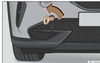
Fig. 44 Paraurti anteriore destro: occhiello di traino avvitato.
