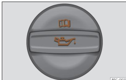
**Fig. 211** Vano motore: tappo del bocchettone di rifornimento dell'olio motore.
