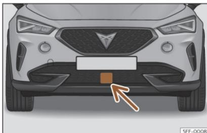
**Fig. 148** Sul paraurti anteriore: sensore radar.
