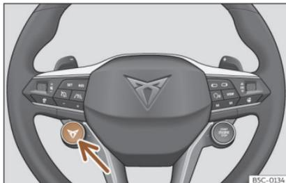
**Fig. 147** Volante multifunzione: tasto per modificare il profilo di guida.
