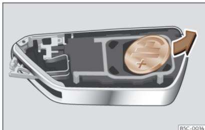
**Fig. 74** Chiave del veicolo: estrarre la batteria.
