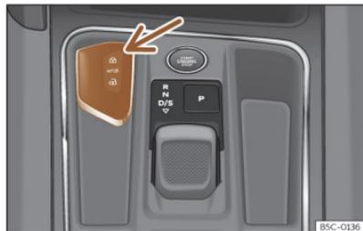
Fig. 71 Console centrale: alloggiamento della chiave di accensione.
