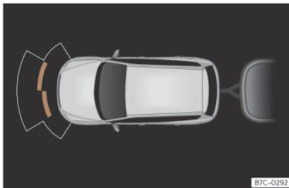
**Fig. 179** Visualizzazione del sistema di controllo per il parcheggio sul display con rimorchio agganciato.
