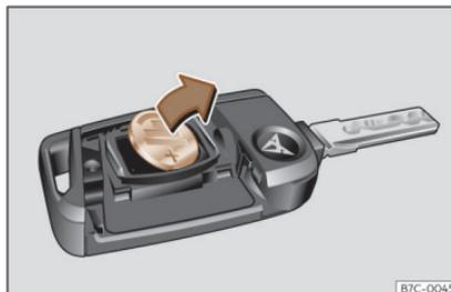
**Fig. 68** Chiave del veicolo: estrarre la batteria.
