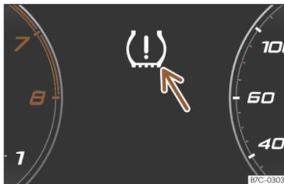
Fig. 207 Quadro strumenti: avviso di calo di pressione degli pneumatici.
