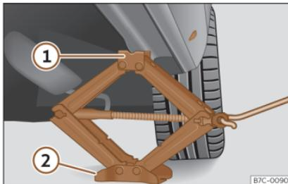
Fig. 36 Longherone: posizionamento del cric del veicolo.
