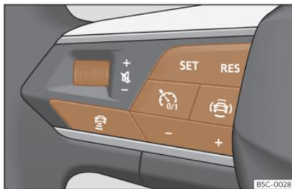
**Fig. 154** Sul volante multifunzione: tasti di comando dell'ACC
