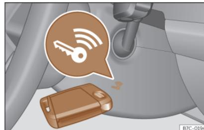
**Fig. 135** A destra del piantone dello sterzo: avviamento di emergenza.
