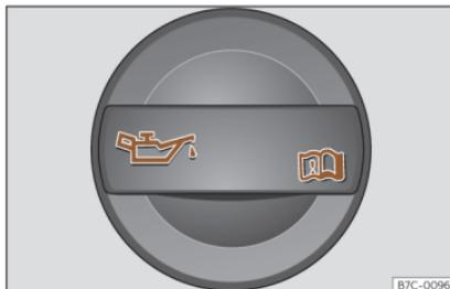
**Fig. 198** Vano motore: tappo del bocchettone di rifornimento dell'olio motore.
