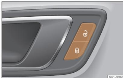
Fig. 70 Porta del conducente: interruttore della chiusura centralizzata.
