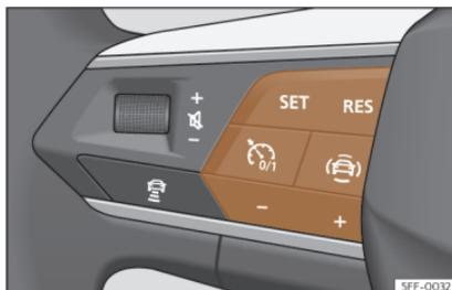
**Fig. 149** Sul volante multifunzione: tasti per gestire il regolatore di velocità
