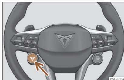
**Fig. 142** Volante multifunzione: tasto per modificare il profilo di guida.
