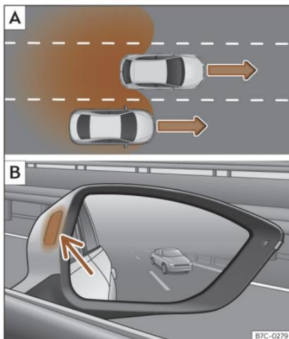
**Fig. 166** Rappresentazione schematica: **A**) Situazione in un sorpasso e incorporamento successivo alla corsia destra. **B**) Indicazione dell'assistente al cambio corsia sullo specchietto retrovisore esterno destro.
