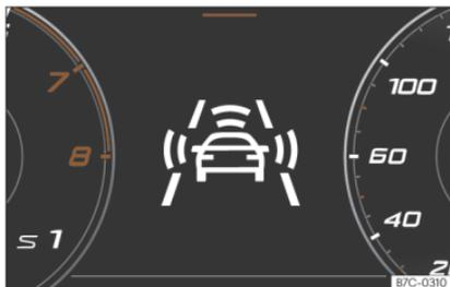
Fig. 151 Sul display del quadro strumenti: indicazioni di preavvertimento.
