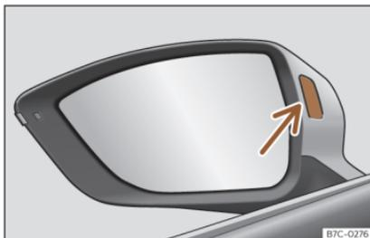
**Fig. 163** Spia di controllo assistente al cambio corsia.
