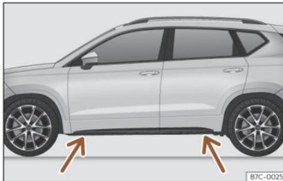
Fig. 35 Punti di appoggio per il cric.
