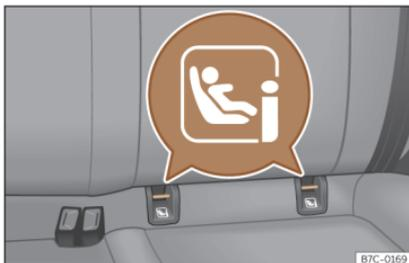
**Fig. 25** Sedile posteriore: occhielli di fissaggio ISOFIX/i-Size.
