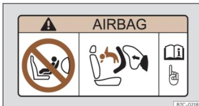
Fig. 23 Adesivo dell'airbag: nell'aletta parasole del lato passeggero
