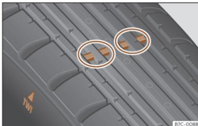
**Fig. 205** Spessore del battistrada dello pneumatico: indicatori di usura.
