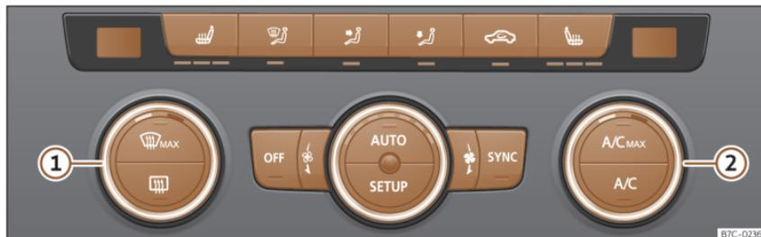
**Fig. 124** Sulla console centrale: comandi del Climatronic.
