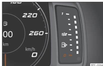
**Fig. 54** Indicatore del livello del carburante.
