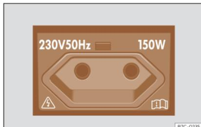
Fig. 123 Sul lato sinistro del bagagliaio: presa elettrica da 230 Volt.
