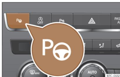
**Fig. 170** Nella parte superiore della consolle centrale: tasto per inserire l'assistente al parcheggio.
