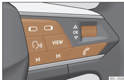
**Fig. 56** Lato destro del volante multifunzione: tasti per l'utilizzo dei menu e delle indicazioni informative del quadro strumenti (a seconda della versione).
