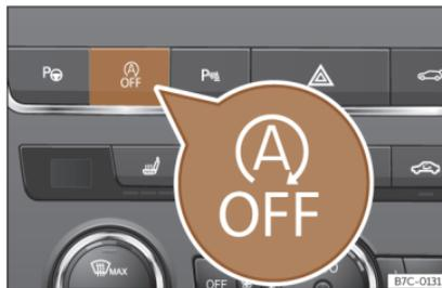
**Fig. 136** Console centrale: tasto del sistema Start/Stop.
