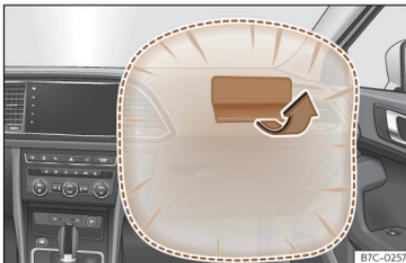
**Fig. 14** Airbag del passeggero sul cruscotto.
