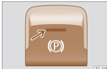
**Fig. 168** Nella parte inferiore della console centrale: tasto del freno di stazionamento elettronico.
