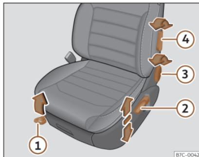
**Fig. 96** Sedili anteriori: regolazione manuale del sedile.
