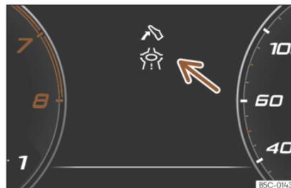
Fig. 53 Indicazione di assistenza per una guida eco-efficiente (rappresentazione schematica).
