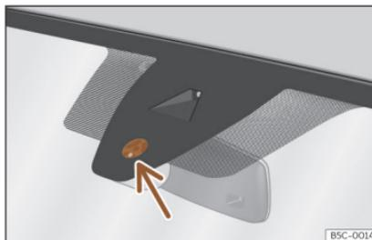
**Fig. 125** Sensore di rilevamento del grado di umidità e della temperatura del parabrezza.
