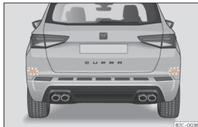
**Fig. 146** Vista posteriore del veicolo: zone dei sensori radar.
