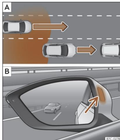
**Fig. 165** Rappresentazione schematica: **A** Situazione in un sorpasso con traffico sulla parte posteriore. **B** Indicazione dell'assistente al cambio corsia sullo specchietto retrovisore esterno sinistro.
