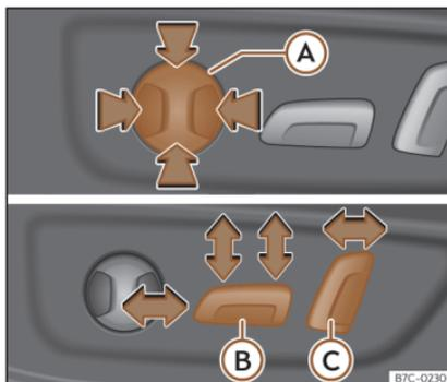
Fig. 97 Sedile del conducente: regolazione elettrica del sedile.
