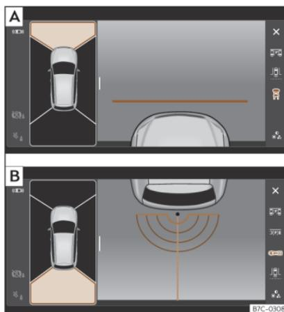
**Fig. 185** Visualizzazione sul display del sistema di visione periferica: **A**) Telecamera anteriore: vista area antistante **B**) Telecamera posteriore: vista area retrostante.
