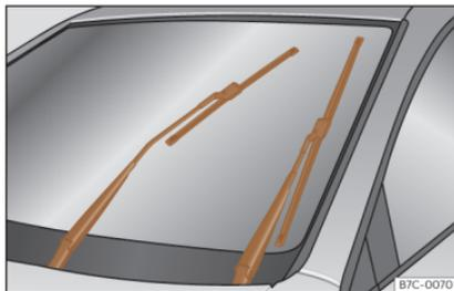
Fig. 37 Tergicristalli in posizione di manutenzione.
