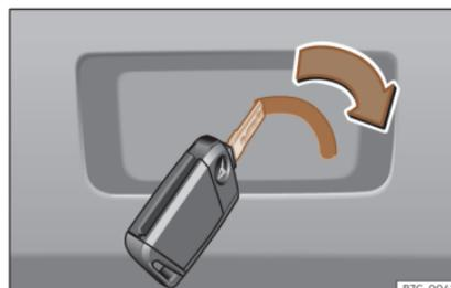
**Fig. 82** Particolare del bagagliaio: sblocco di emergenza.
