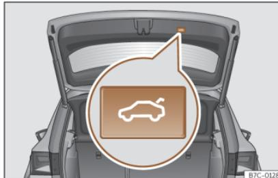
Fig. 78 Portellone posteriore: tasto per chiudere il portellone.
