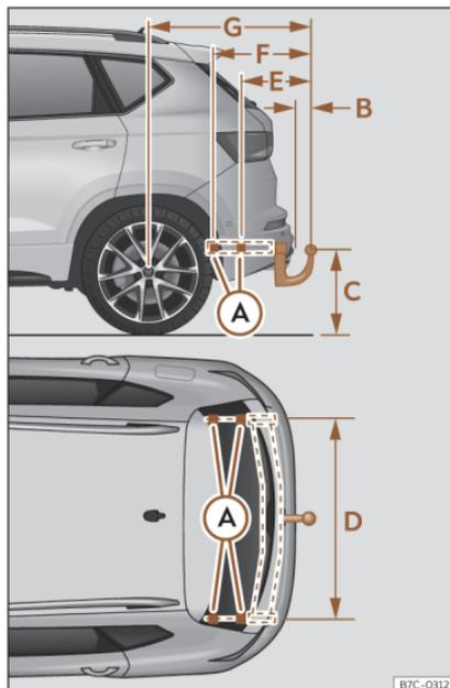
**Fig. 189** Quote e punti di fissaggio per il montaggio successivo di un dispositivo di traino.
