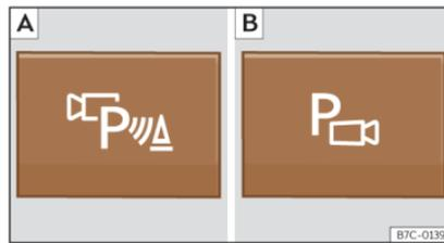
**Fig. 184** Console centrale: tasto per attivare/disattivare manualmente il sistema di visione periferica quando è abbinato all'assistente di parcheggio (**A**) o al sistema Park Pilot posteriore (**B**).
