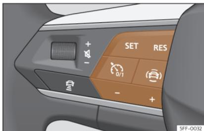
**Fig. 150** Sul volante multifunzione: tasti per gestire il limitatore di velocità
