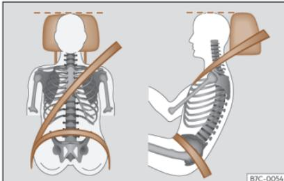
**Fig. 3** Nastro della cintura e poggiatesta posizionati correttamente.
