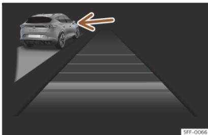
**Fig. 156** Sul display del quadro strumenti: ACC attivo, veicolo rilevato sulla sinistra
