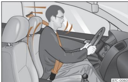
**Fig. 6** I conducenti che hanno la cintura di sicurezza correttamente allacciata non saranno proiettati fuori dal veicolo in caso di frenate repentine.
