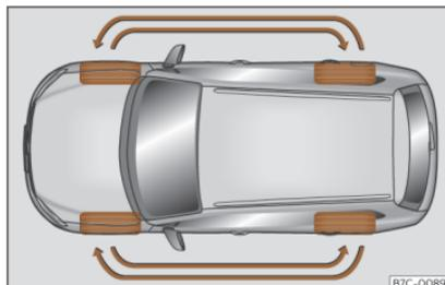
**Fig. 206** Scambio delle ruote.
