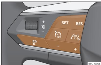
Fig. 162 Lato sinistro del volante multifunzione: tasti per la gestione del Travel Assist.
