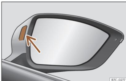
**Fig. 164** Spia di controllo assistente al cambio corsia.
