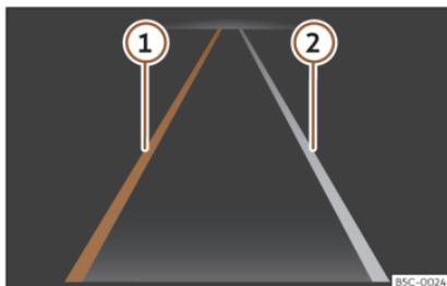
**Fig. 159** Sul display del quadro strumenti: indicazioni del sistema di assistenza per il mantenimento della corsia.
