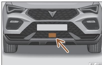
**Fig. 143** Sul paraurti anteriore: sensore radar.
