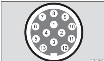
**Fig. 187** Rappresentazione schematica: assegnazione dei pin della presa elettrica per il rimorchio.
