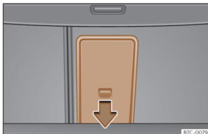
**Fig. 116** Nel bagagliaio: apertura della sponda.
