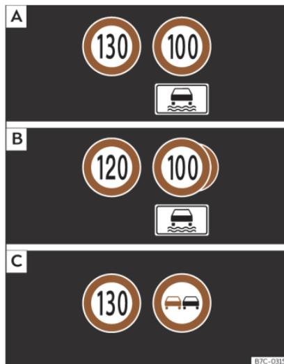
**Fig. 52** Sul display del quadro strumenti: esempi di limiti di velocità o divieti di sorpasso riconosciuti con i rispettivi pannelli complementari.
