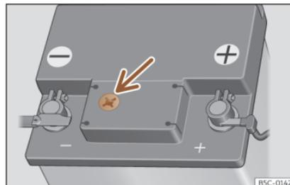
**Fig. 203** Spioncino sopra la batteria da 12 volt (rappresentazione schematica).
