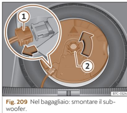
**Fig. 209** Nel bagagliaio: smontare il subwoofer.
