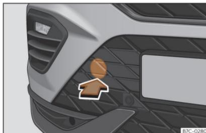
Fig. 41 Sul lato destro del paraurti anteriore: estrarre il coperchio.
