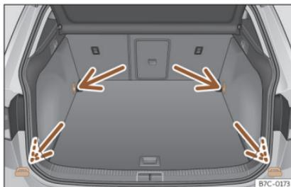
**Fig. 111** Nel bagagliaio: occhielli di ancoraggio.
