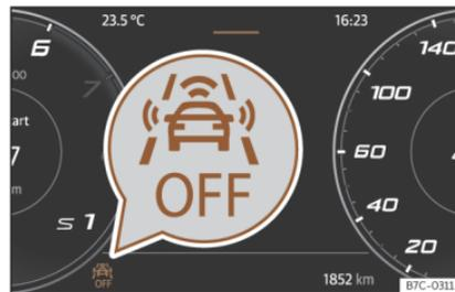
Fig. 152 Sul display del quadro strumenti: indicazione di Front Assist disattivato.
