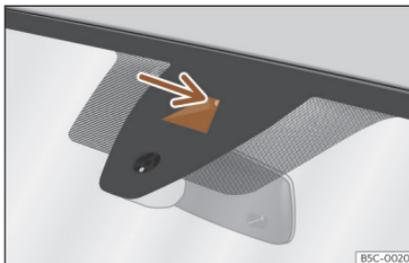
**Fig. 145** Nel parabrezza: area del campo visivo della telecamera del dispositivo di assistenza per il mantenimento della corsia.
