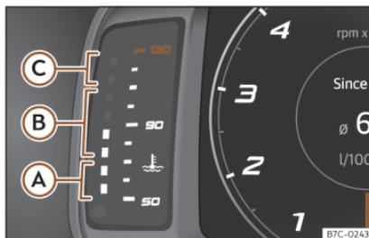
Fig. 55 Indicatore della temperatura del liquido di raffreddamento del motore.
