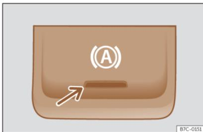
**Fig. 169** Nella parte inferiore della console centrale: tasto della funzione Auto Hold.
