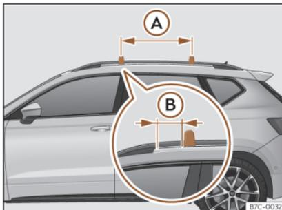
**Fig. 118** Punti di fissaggio delle barre longitudinali per il portapacchi sul tetto.
