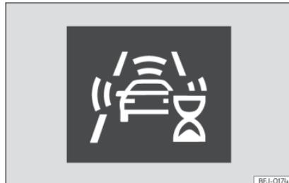
**Fig. 153** Sul display del quadro strumenti: indicazione dell'autocalibrazione iniziale del sistema.
