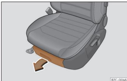
**Fig. 120** Rangements sous les sièges avant.
