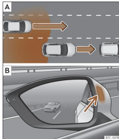
**Fig. 165** Représentation schématique : **A** En cas de dépassement en présence de trafic à l'arrière du véhicule. **B** Indication de l'assistant de changement de voie sur le rétroviseur extérieur gauche.
