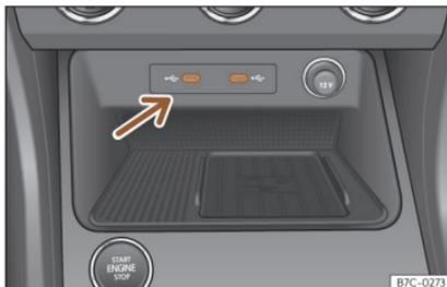
Fig. 132 Console centrale : entrée USB.
