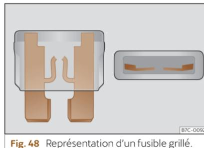
**Fig. 48** Représentation d'un fusible grillé.
