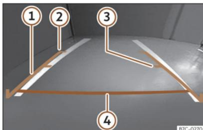
Fig. 186 Écran du système d'infodivertissement : lignes d'orientation.
