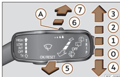
**Fig. 91** Commande de l'essuie-glace avant et arrière.
