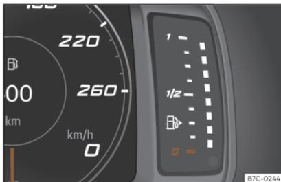
Fig. 54 Indicateur du niveau de carburant.
