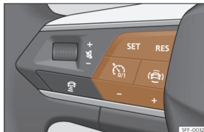
**Fig. 150** Sur le volant multifonction : boutons permettant d'actionner le limiteur de vitesse
