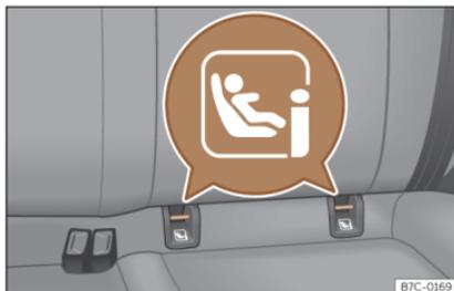
**Fig. 25** Banquette arrière : anneaux de fixation ISOFIX/i-Size.
