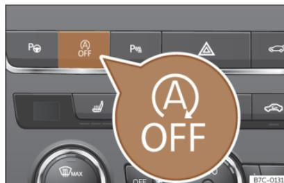
**Fig. 136** Console centrale : touche du système Start-Stop.
