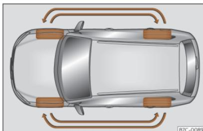
Fig. 206 Permutation des roues.
