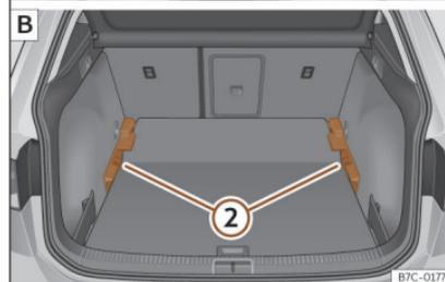
**Fig. 109** Plancher de coffre à bagages modulable : [A] position haute ; [B] position basse.
