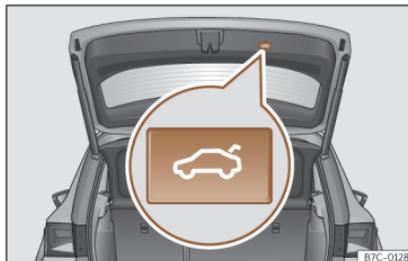
Fig. 78 Hayon : touche de fermeture du hayon
