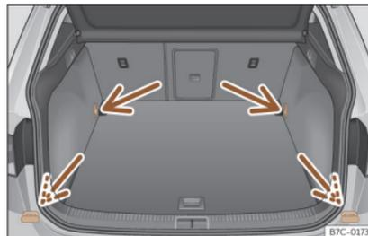
Fig. 111 Dans le coffre à bagages : œillets d'arrimage.
