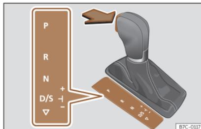
Fig. 137 Verrouillage du levier sélecteur.
