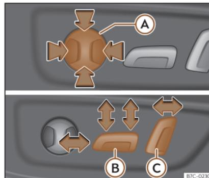
Fig. 97 Siège du conducteur : réglage électrique du siège.
