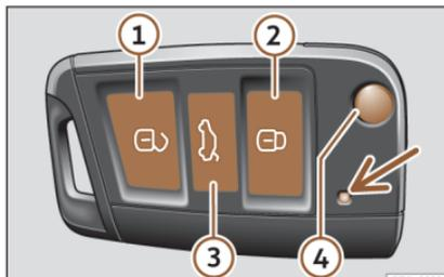
**Fig. 65** Touches de la clé à radiocommande.
