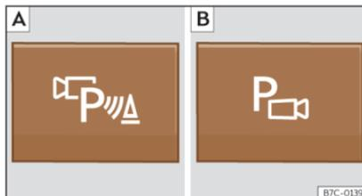
**Fig. 184** Console centrale : touche permettant d'activer ou de désactiver manuellement le système de vision périphérique lorsqu'il est associé au système de stationnement assisté (A) ou avec le système Park Pilot arrière (B).
