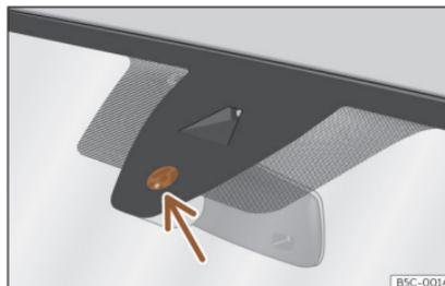
**Fig. 125** Capteur d'humidité et de température du pare-brise.
