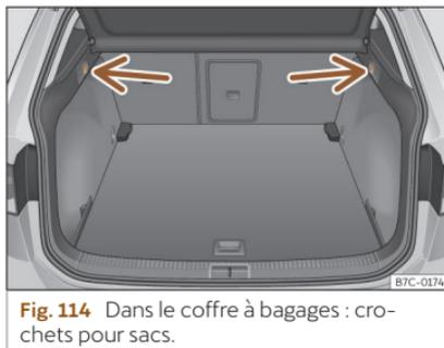
**Fig. 114** Dans le coffre à bagages : crochets pour sacs.
