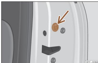
**Fig. 75** Verrouillage d'urgence de la porte.
