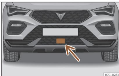
Fig. 143 Au niveau du pare-chocs avant : capteur radar.
