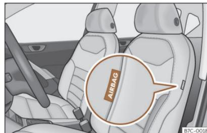
**Fig. 19** Airbag latéral dans le siège du conducteur.
