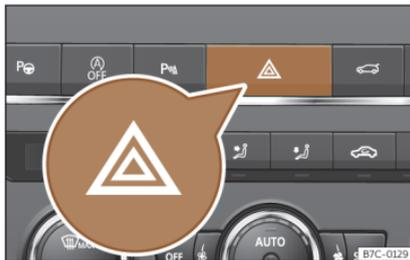
**Fig. 90** Planche de bord : commande des feux de détresse.
