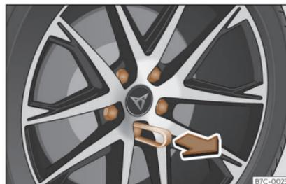
Fig. 32 Roue : boulons de roue avec capuchons.
