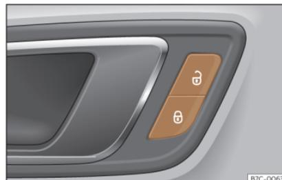
Fig. 70 Porte du conducteur : commande de verrouillage centralisé.
