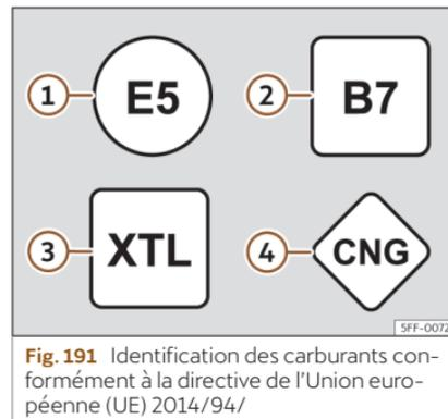
**Fig. 191** Identification des carburants conformément à la directive de l'Union européenne (UE) 2014/94/
