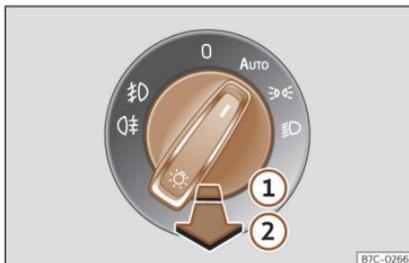
Fig. 88 Planche de bord : commande des feux.
