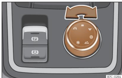
**Fig. 141** Console centrale : Commande rotative (Driving Experience button).
